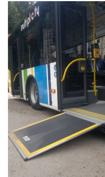
Izgled niskopodnog autobusa sa automatskom rampom ispod srednjih vrata autobusa Grad Luksemburg
