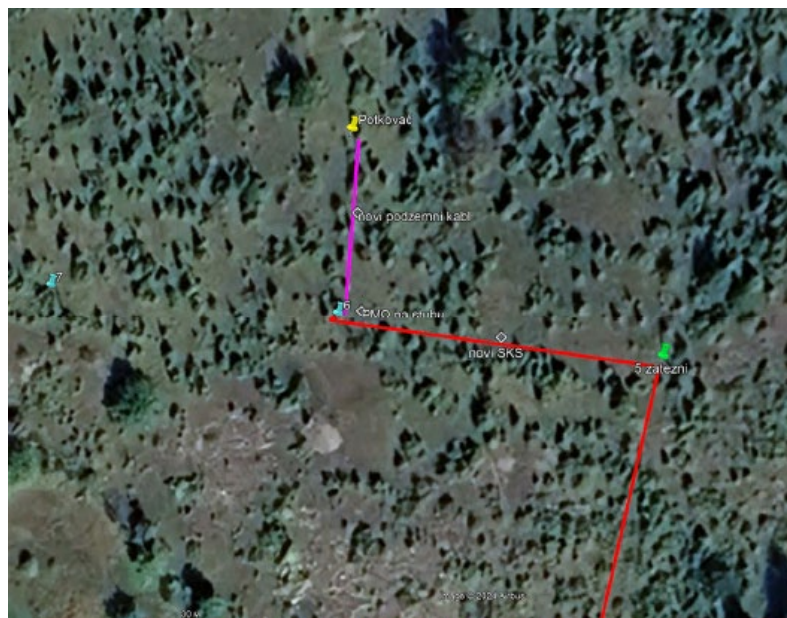
Slika 3.3. Elektroenergetski priključak na Google Earth mapi
