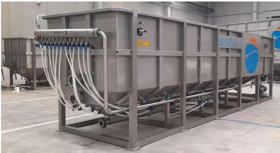
Sl. 3.1.4. Postrojenje za preradu otpadnih voda iz procesa proizvodnje DAF FPAC
